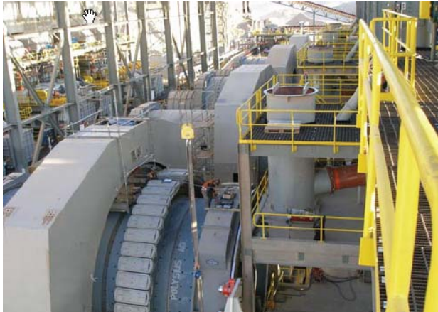
Bild 7 Der Energiebedarf getriebeloser Mühlenantriebe ist um Getriebeverluste verringert
