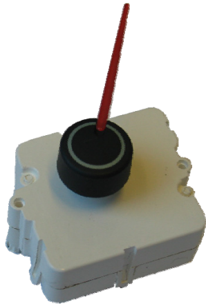
Bild 9 MiniPAD als Zeigerantrieb. Produktnahes Muster
